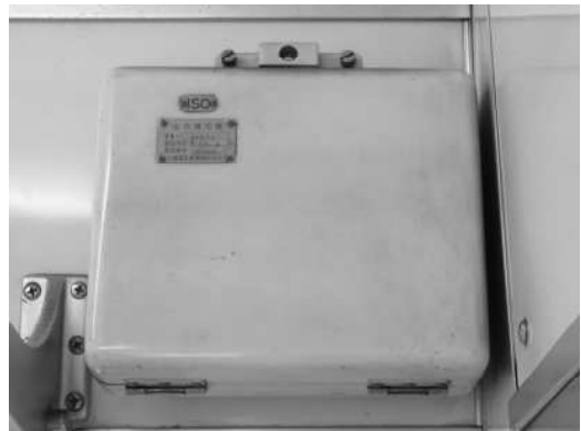
↑ 角型の形状の前・中期車(右)と丸型の形状の後期車の増幅器(左)
